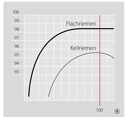
Wirkungsgrad eines Flachriemens (oben); Wirkungsgrad eines Keilriemens (unten). Siegling Extremultus Flachriemen haben einen Wirkungsgrad von 98,6 %.
