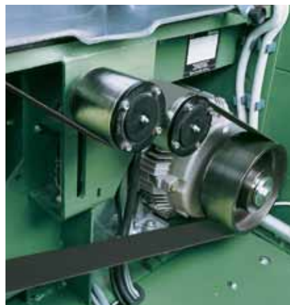
Streckenantrieb (Textilindustrie/Garnherstellung), Bandtyp GG 20E-20 NSTR/FSTR grau/schwarz
