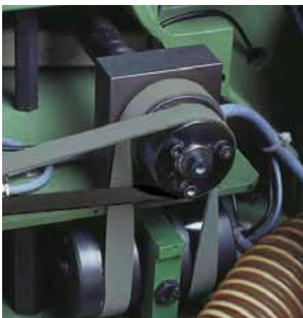
Streckenantrieb (Textilindustrie/Garnherstellung), Bandtyp GG 20E-20 NSTR/FSTR grau/schwarz
